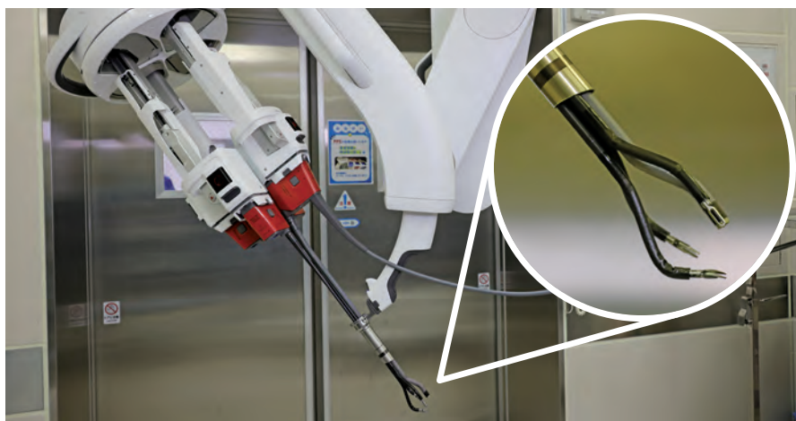
ダビンチ SPのアームの先端部分 アーム同士がぶつかることがなく、先端部分は人間の手のように柔軟に動くため、より感覚的な操作が可能。口からロボットを挿入できる咽頭・喉頭がんなどの手術で特に効果を発揮するとみられる。
