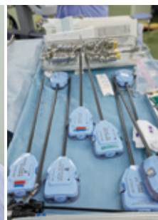
ロボットアームの先に装着する手術用鉗子。用途に合わせて4～5種類を使い分ける。
