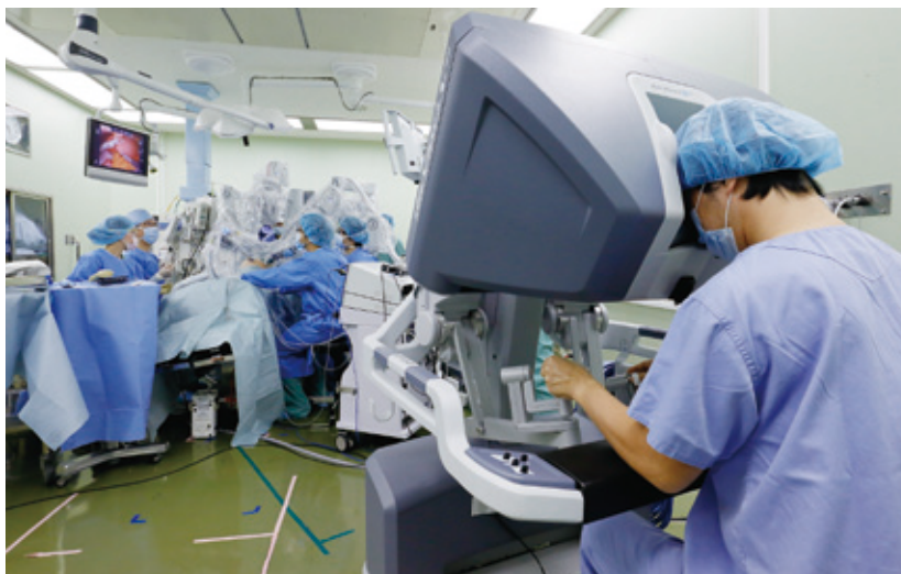
操作席（サージョンコンソール）に座り、腹腔内の3次元画像を見ながら、ロボットアームを遠隔操作し手術を進める木下医師。
