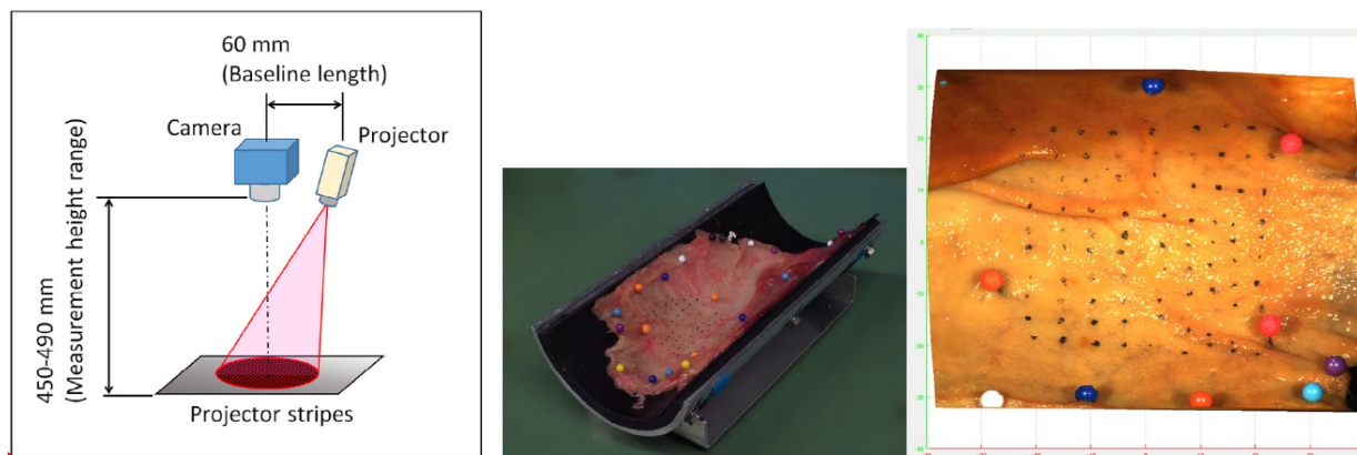
位相シフト法による内視鏡下三次元形状計測システムの開発
