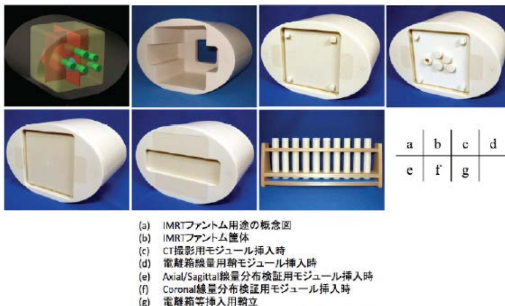
Figure 1 IMRT ファントムと各種内部挿入用モジュール
