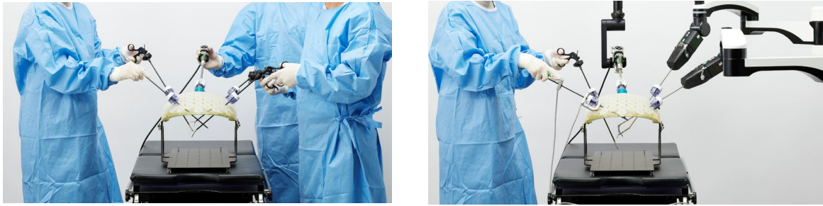
図1：腹腔鏡手術(左)と ANSUR サージカルユニット(右)との比較。2 人で行う助手とスコピストの作業を 1 台の ANSUR サージカルユニットが担う、新しいコンセプトの手術支援ロボットを開発。
